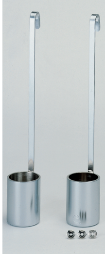
Copas con asa. Modelos DIN 53211 Nº 4 y Ford ASTM D-1200.
