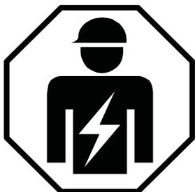
Para la identificación de equipos y productos electrotécnicos. La instalación del producto identificado de este modo exige conocimientos electrotécnicos especiales.
