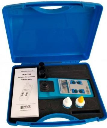
Conjunto en maletín para medida de turbidez en agua y aguas residuales tanto en campo como en laboratorio y, hueco para 2 checker y 3 tester.
