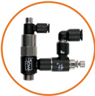
Estos racores incluyen una válvula NC monoestable de mando neumático, una función de regulación de caudal y un purgador rápido (modelo 7894).
